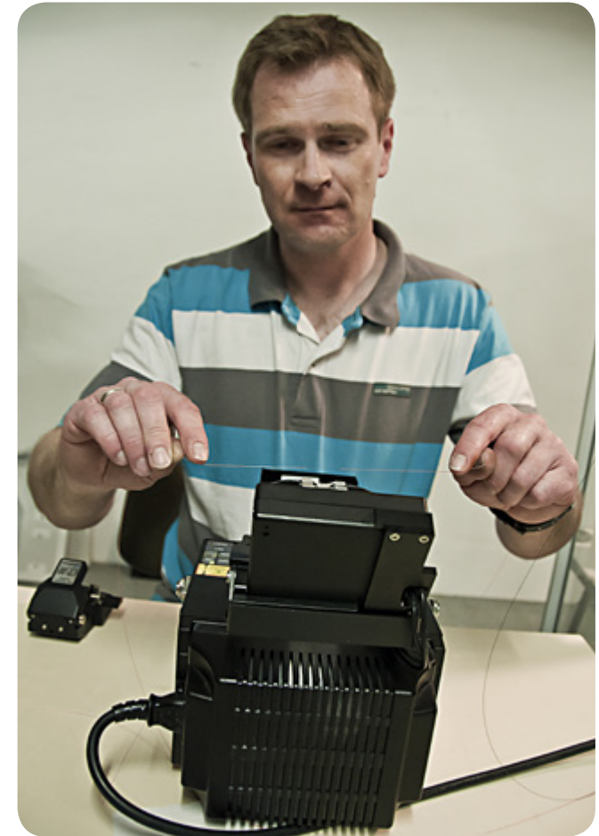
ZIV-Mitarbeiter Martin Hans fügt mit einem Lichtbogenspleißgerät Glasfasern punktgenau zusammen.
