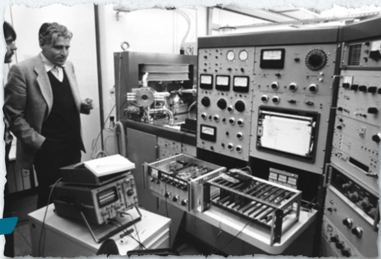
Im Zentrallaboratorium für Geochronologie begutachtet Prof. Dr. Borwin Grauert 1978 einen Festkörpermassenspektrometer mit elektrischem Bedienapparat.
