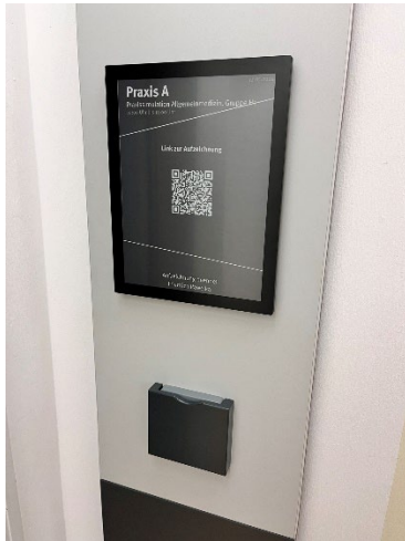
Abbildung 1: RFID-Reader und eInk-Display
