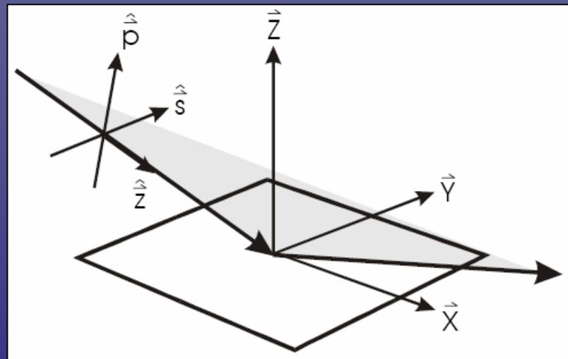
Bei einem Reflexionsexperiment bezieht man sich zur Beschreibung der EM-Welle auf ein Koordinatensystem, welches durch die Einheitsvektoren  $\vec{z}$ ,  $\vec{s}$  und  $\vec{p}$  aufgespannt wird und die durch die Einfallsebene und Ausbreitungsrichtung des Lichts festgelegt sind.
