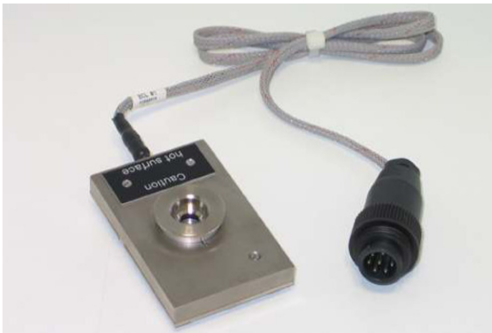
Abbildung 8: beheizbarer Probenhalter für das IFS 66v/S
