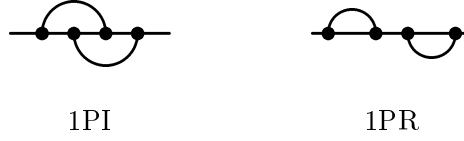
Abb. 5: Der linke Graph ist 1PI. Im Gegensatz dazu kann man den rechten Graphen splitten, indem man die mittlere Linie entfernt. Deshalb ist er one particle reducible (1PR).
