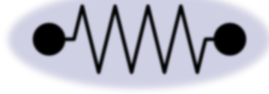
Abb. 3.2. Skizze eines idealisierten Rotors: Zwei Punktwirbel werden durch eine überdämpfte Feder zusammengehalten
