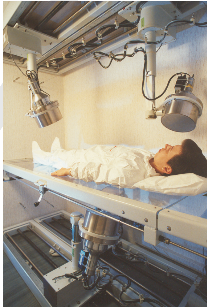
Abb. 12.2: Ganzkörperzähler zur Messung gamma-strahlender Radionuklide im menschlichen Körper
