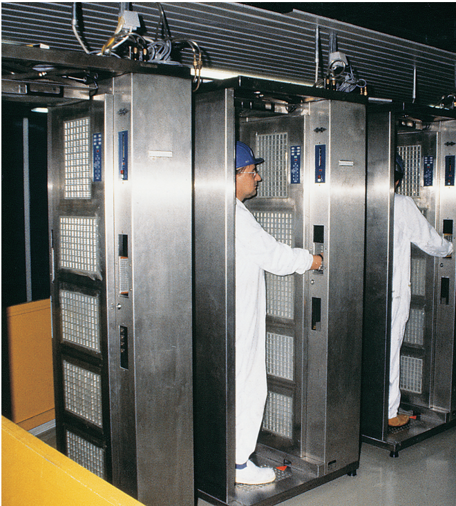
Abb. 5.4: Ganzkörper-Monitor mit großflächigen Proportionalzählern an einem Kontrollbereichsausgang
