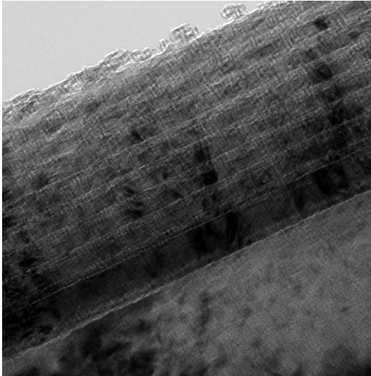
Abbildung 2.6 – Ungefilterte Aufnahme eines Eisen-Chrom Schichtsystems [10] im Elektronenmikroskop.
