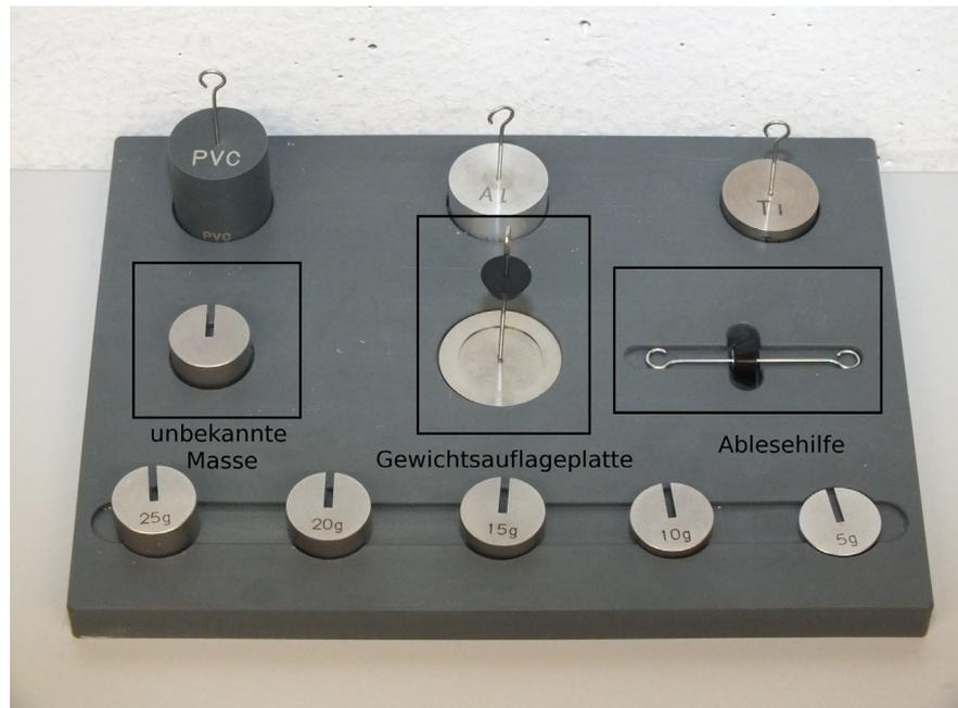
**Abbildung 3.8:** Für diesen Versuch benötigte Massen und Aufhängungen
