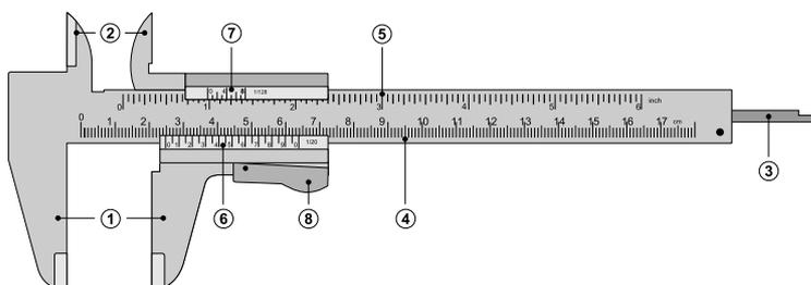
**Abbildung 1.7:** Schematische Darstellung eines Messschiebers. Legende: (1) Außenmaß, (2) Innenmaß, (3) Tiefenmaß, (4) Hauptskala (cm), (5) Hauptskala (Zoll), (6) Nonius (cm), (7) Nonius (Zoll), (8) Feststellhebel
