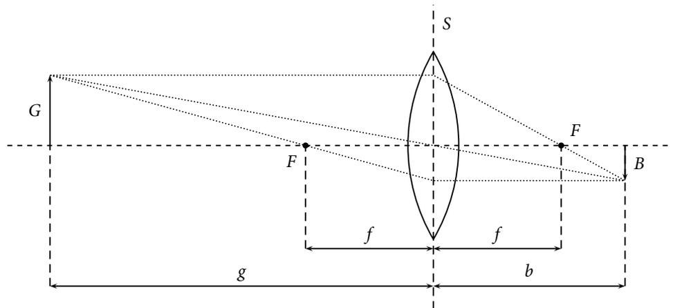
**Abbildung 9.4:** Konstruktion eines Bildes einer Sammellinse
