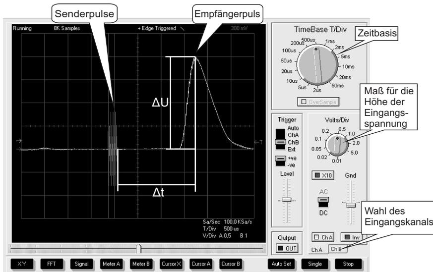
**Abbildung 17.7:** Darstellung der im Praktikum genutzten Oszilloskop-Software
