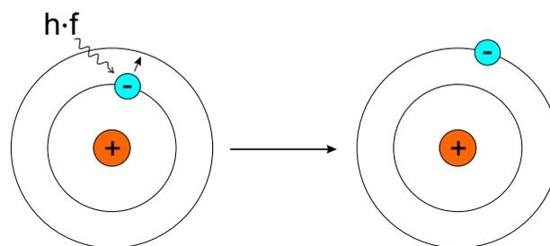
**Abbildung 11.1:** Durch Absorption von Licht können elektronische Übergänge in Atomen und Molekülen induziert werden (vereinfachte Darstellung)
