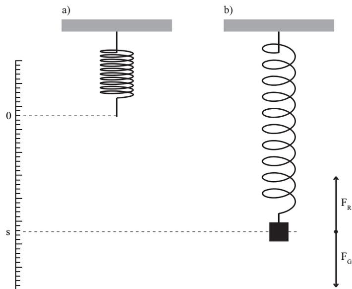
**Abbildung 3.3:** Federwaage: a) Schraubenfeder ohne Belastung, b) Auslenkung der Feder durch angehängtes Gewicht.
