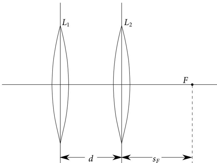
**Abbildung 9.9:** Linsenkombination: Zwei Linsen  $L_1$  und  $L_2$  mit den unterschiedlichen Brennweiten  $f_1$  und  $f_2$
