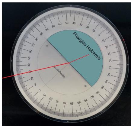
**Abbildung 9.11:** Halbkreis aus Plexiglas in Position für die Bestimmung des Brechungsindex von Plexiglas mit Hilfe des Brechungsgesetzes nach Snellius
