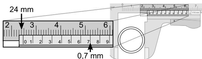
**Abbildung 1.8:** Messung des Außendurchmessers eines Rohres mit Hilfe eines Messschiebers.
