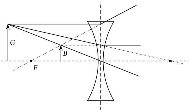
**Abbildung 9.5:** Konstruktion des Bildes einer Zerstreungslinse
