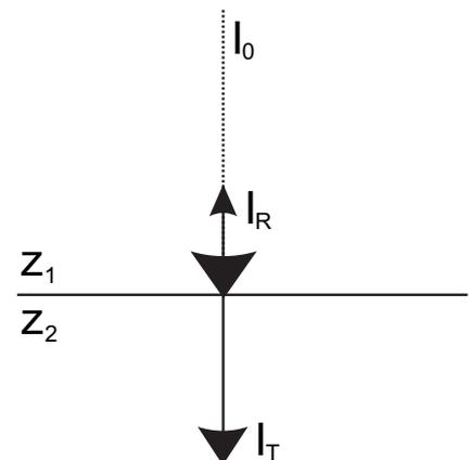
**Abbildung 17.2:** Reflexion und Transmission an einer Grenzfläche bei senkrechtem Einfall der Ultraschallwellen
