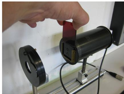
**Abbildung 9.15:** Haltevorrichtung für Farbfilter
