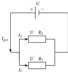
Abbildung 13.4: Parallelschaltung
