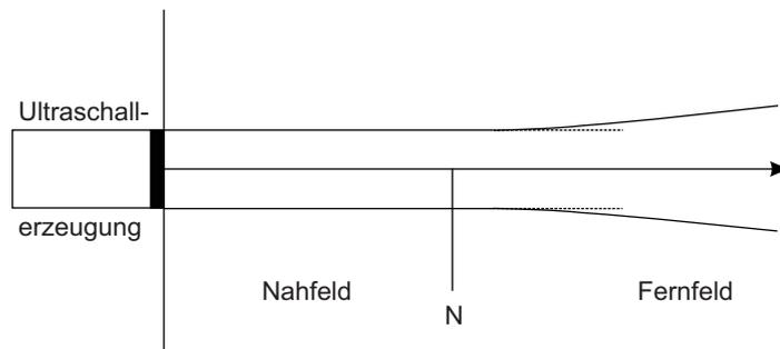
**Abbildung 17.4:** Schematische Darstellung des Schallfeldes einer Ultraschallwelle
