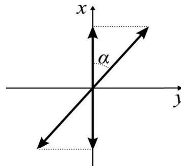
**Abbildung 12.3:** Durch den Analysator wird der Anteil  $E_0 \cos(\alpha)$  der elektrischen Feldstärke transmittiert.
