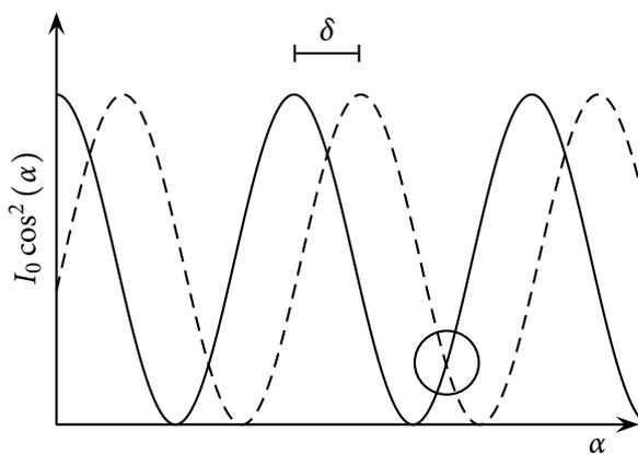
**Abbildung 12.5:** Drehwinkelabhängige Intensitätszerlegung in der Okularebene eines Halbschattenpolarimeters. Der Kreis markiert die Stelle gleicher Dunkelheit (Halbschattenstellung).
