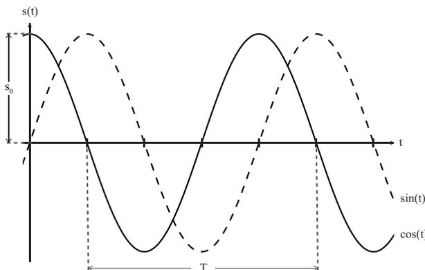
**Abbildung 3.5:** Trigonometrische Funktionen. Die Amplitude  $s_0$  und die Periode  $T$  sind eingezeichnet.
