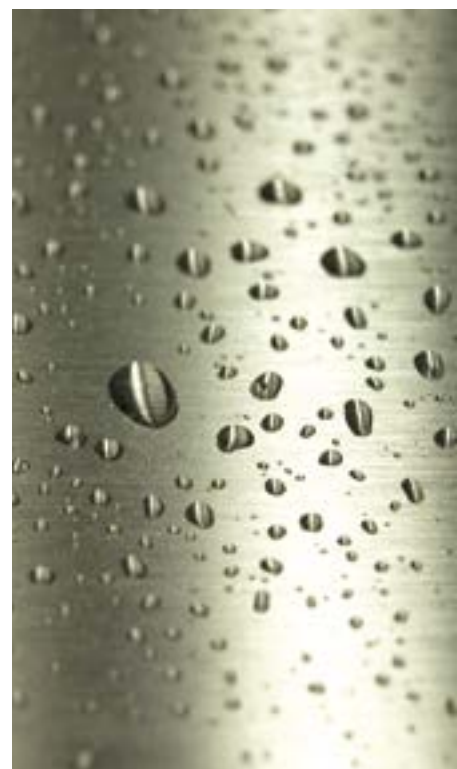
Metalloberfläche, die durch Nanobeschichtung hydrophob gemacht wurde.
