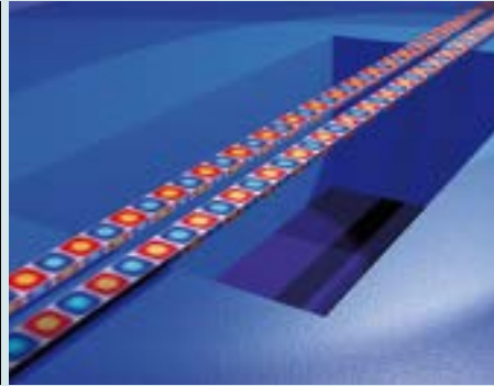
Optischer Schaltkreis mit Wellenleitern und photonischen Elementen. Rechts sind zwei freitragende Wellenleiter zu sehen, die über den Strahlungsdruck angeregt werden.
