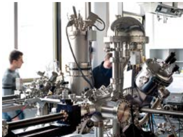
Um hochdefinierte Versuchsbedingungen zu schaffen, werden Experimente im Ultrahochvakuum und bei Temperaturen nahe dem absoluten Nullpunkt durchgeführt.
