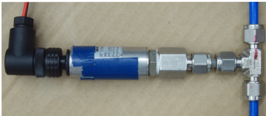
Abbildung 2.3: Abgebildet ist der verwendete Drucksensor in Draufsicht. Rechts ist der Schlauch des Gassystems zu erkennen. Oben links ist ein Stück des zum Arduino führenden Kabels zu sehen.
