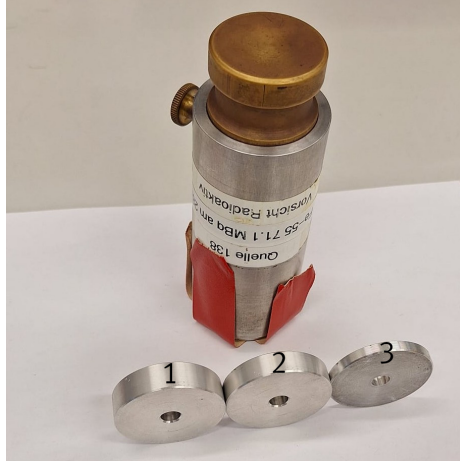
Abbildung 4.1: Foto der Quellhalterung und drei verschiedenen Kollimatoren.
