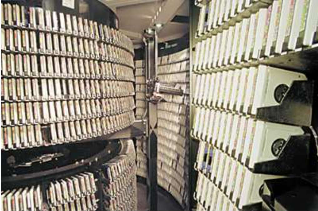
Abbildung 3.7: Symbolfoto: Ein HPSS besteht aus einem Magazin mit Magnetspeicherbändern, die automatisch per Robotergriffarm eingelagert und wieder an die Einlesepunkte gebracht werden.
