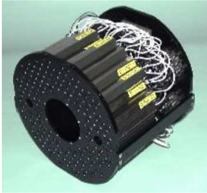
Abbildung 3.3: Ein Beam-Beam-Counter. Mit seinem Loch in der Mitte wird er direkt auf der Strahlachse positioniert.
