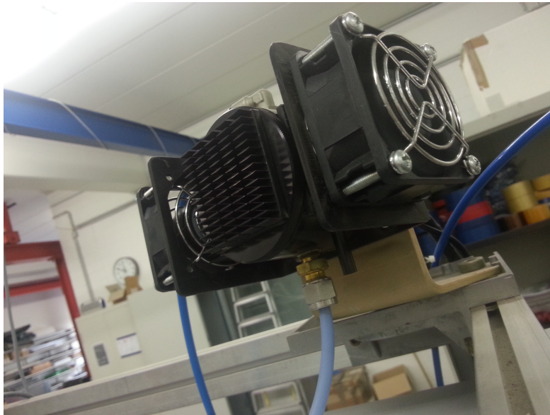
Abbildung 3.3: S3-Sensor mit zusätzlicher Kühlung über zwei Ventilatoren.
