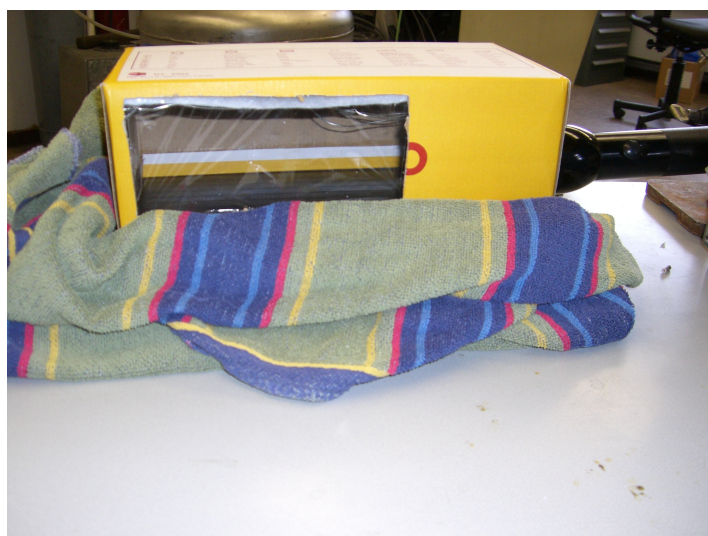
Abbildung 8.3: Experimenteller Aufbau der improvisierten Nebelkammer
