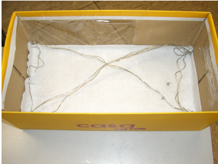
Abbildung 8.1: Gerüst der Selbstbau-Nebelkammer aus einem Schuhkarton, Filz, Modellierdraht und Frischhaltefolie
