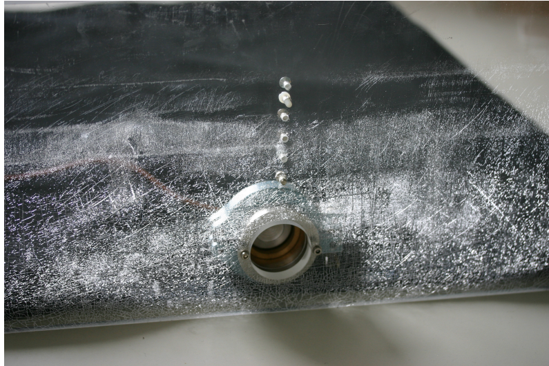
Abbildung 4.1: Wandrahmen der Testkammer nach dreimonatiger Verwendung. Die mittige Öffnung diente der Einführung von radioaktiven Präparaten.
