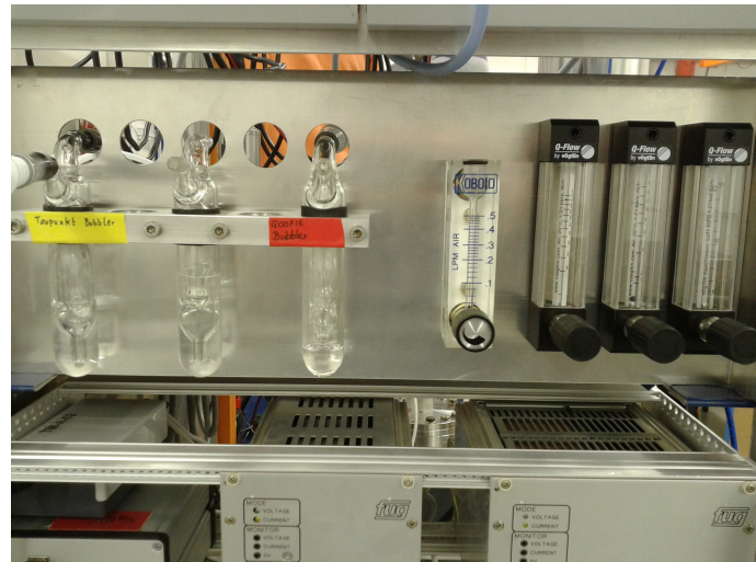
Abbildung 10: Ausschnitt des Aufbaus mit Bubbler (gelb markiert, links) und Flussreglern (rechts).
