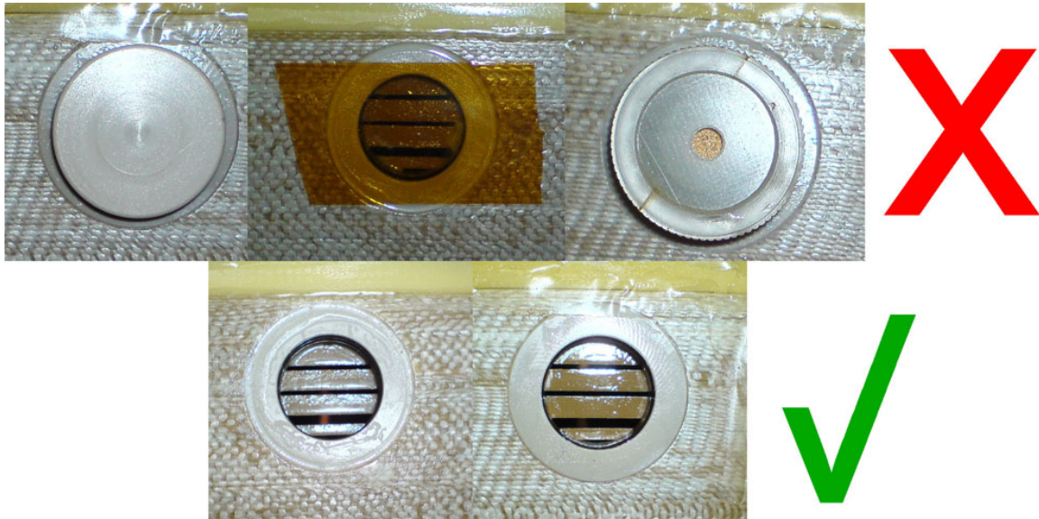
Abbildung 6.8: Gasverbinder am Auslass: richtig und falsch
