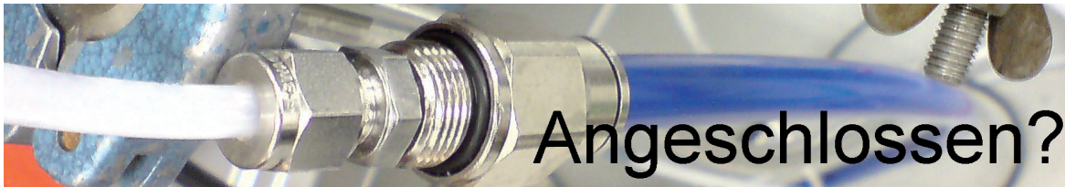
Abbildung 6.12: Bevor der Unterdrucktest durchgeführt wird, muss der blaue Druckschlauch an das Orbisphere-Setup angeschlossen werden, da der Lüfter ansonsten keinen Unterdruck in der Lage erzeugen kann.
