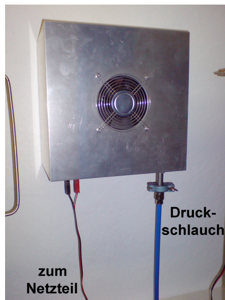
Abbildung 6.13: Der Diagonallüfter in der Box erzeugt einen Unterdruck im blauen Druckschlauch.
