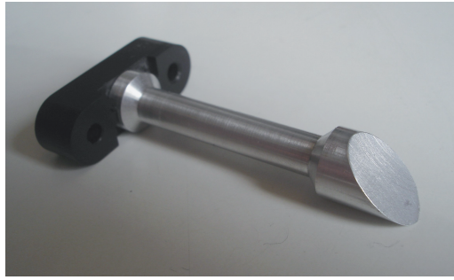
Abbildung 3.10: Der Aluminiumreflektor, welcher neben dem Kupferreflektor für den Versuchsaufbau getestet wurde.
