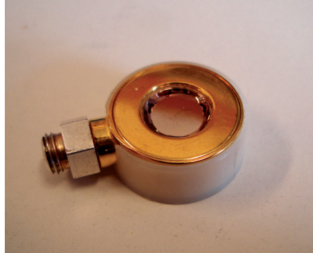
Abbildung 4.11: Foto eines der verwendeten Oberflächen-Sperrschicht-Zählers. In der Mitte ist die aktive, mit Gold bedampfte Fläche zu sehen.
