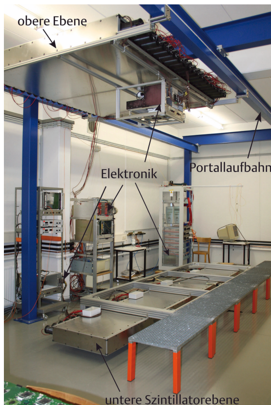
Abbildung 6.1: Aufbau des Triggers am Institut für Kernphysik an der WWU.
