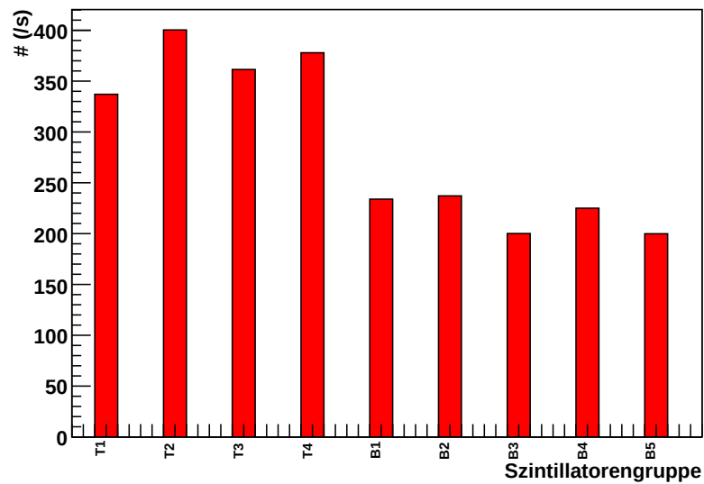
Abb. 6.13.: Hier sind die Zählraten der einzelnen Szintillatorengruppen aufgetragen. Es ist gut zu erkennen, dass jeweils die Gruppen der unteren Ebene und der oberen Ebene ungefähr gleiche Raten liefern. Der Unterschied zwischen einer Gruppe aus Top und einer Gruppe aus Bottom ist jedoch auffällig. Eine Erklärung dafür ist die größere aktive Fläche einer Top-Gruppe.
