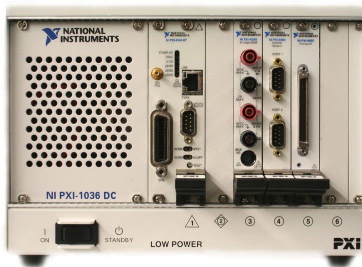
Abbildung 4.3: Die PXI-Einheit des Positionssystems. In dem Chassis (PXI-1036 DC) ist der Controller (PXI-8146 RT) in Steckplatz 1 eingebaut, um in Echtzeit mit den Motoren arbeiten zu können. Die CAN-Schnittstellenkarte (PXI-8464/2-Serie 2) befindet in Steckplatz 4 und ermöglicht die unabhängige Steuerung beider Motoren. Die Counterkarte zur Datenerfassung (PXI-6602) ist in Steckplatz 5 zu sehen. Diese drei Module werden für die Motorsteuerung genutzt. Das Modul in Steckplatz 3 wird nicht benötigt.
