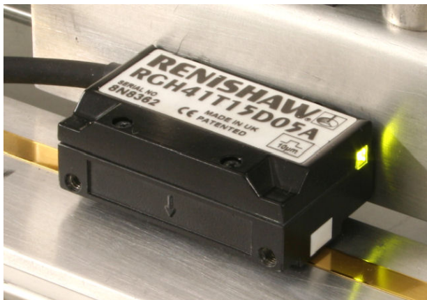
Abbildung 4.8: Links: Linearmesskopf der Firma Renishaw mit goldenen Maßband. Die grüne LED auf der Stirnseite des Messkopfes zeigt eine korrekte Justage an. Rechts: Die beiden um 90^\circ verschobenen Signale, die erzeugt werden, sobald ein Inkrement des Maßbandes überfahren wird. Eingezeichnet sind die Signalperiode und die daraus resultierende Auflösung der Messköpfe.
