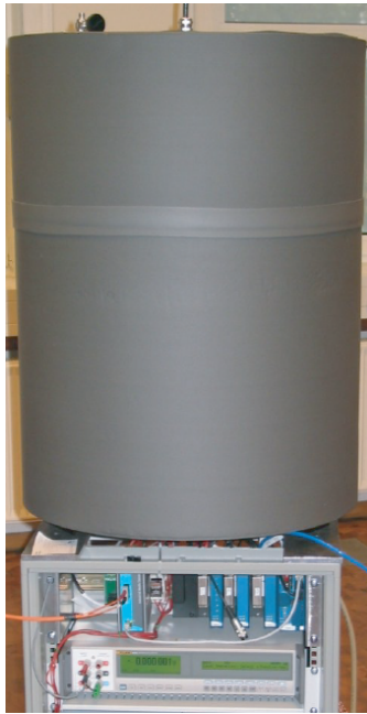
Abbildung 6: Archivfoto (Bildausschnitt) des etwa 1,70 m hohen Spannungsteilers K35 während der Testmessungen im Labor der PTB Braunschweig. [Thu07]
