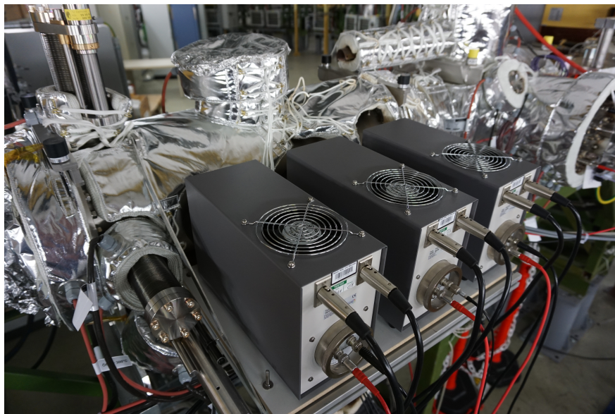
Abbildung 6.1: Am CRYRING eingebaute PMTs mit Kühlgehäuse[6]
