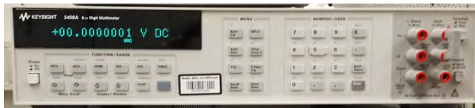
Abbildung 7.1: Frontalansicht des Keysight 3458A Präzisionsmultimeters.
