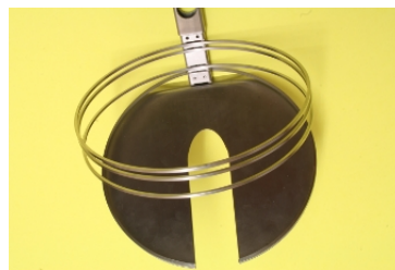
Abbildung 7: Kathodenplatte mit Ringelektroden 1 -4
