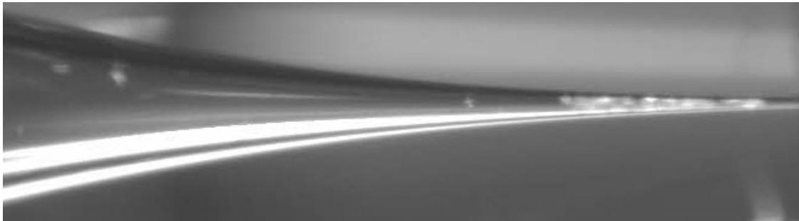
Abbildung 2.30.: Verstopfte Düse. Die Verunreinigungen in der Düsen Spitze sind im rechten Teil des Bildes als weiße Objekte zu erkennen.
