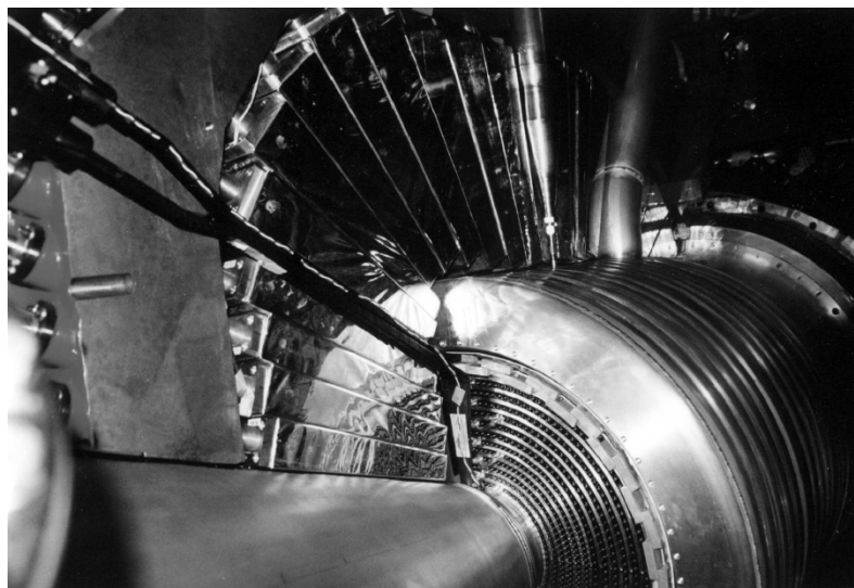
Abbildung 2.16.: Fotografie des Zentraldetektors. Die Mini Drift Chamber ist umgeben von Elementen des Plastic Scintillator Barrel. Noch weiter außen sind auch Elemente des Kalorimeters zu sehen.
