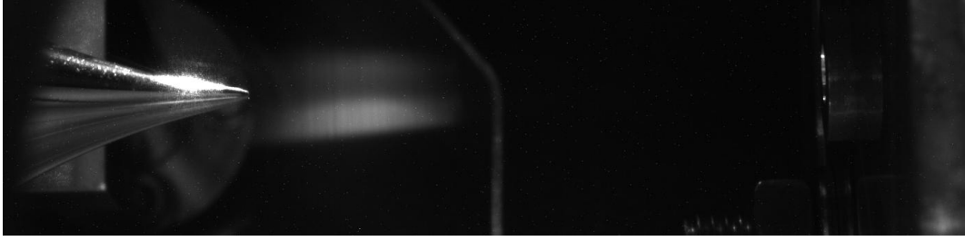
Abbildung 5.36: Aufnahme des Clusterstrahls in der Skimmerkammer bei 22 K und 17,5 bar. Der hellste Bereich des Clusterstrahls wird nicht vom Skimmer extrahiert.
