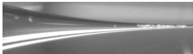
Abbildung 4.19: Mikroskopische Aufnahme einer blockierten Düse [Win11]. Es sind deutlich Fremdkörper in der Spitze des Strömungskanals zu erkennen.
