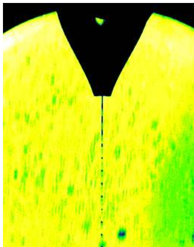
Abbildung 4.20: Falschfarbenbild des Dropletstrahls mit Piezobetrieb [Nor04]. Oben im Bild ist der Ausgang der Glasdüse zu erkennen. Direkt hinter der Glasdüse ist die Verformung des Flüssigkeitsstrahls zu erkennen, die weiter unten zum Aufbruch in einzelne Droplets führt. Die Droplets werden mit einer Stroboskoplampe sichtbar gemacht, welche mit gleicher Frequenz und in Phase mit dem Piezo betrieben wird.
