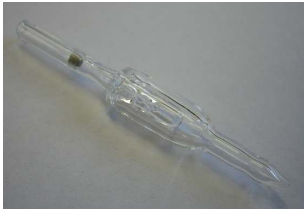
Abbildung 7.1: Links: Vorschlag für ein neues Düsendesign von A. Khoukaz. Rechts: Entsprechend dem Schema im linken Bild gefertigter Prototyp. Zu erkennen ist der eingeschmolzene Sinterfilter am Düsen-eingang, die in den Strömungskanal der Düse eingelassene Kammer, sowie der Strömungskanal selbst.
