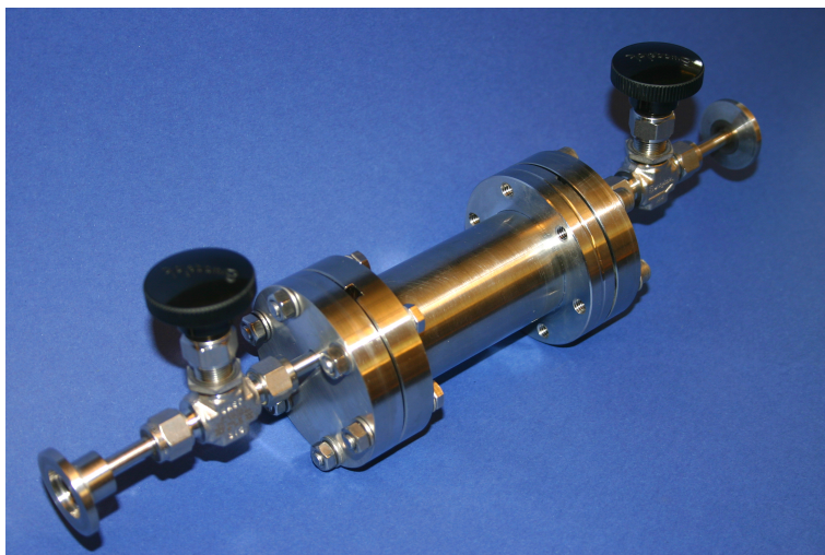
Abbildung 3.18.: Zusammengebaute Kalibrierungsquelle, die auf einer Seite mit der Luftpumpe und auf der anderen Seite mit einem Plastigas ® -Beutel verbunden werden kann.
