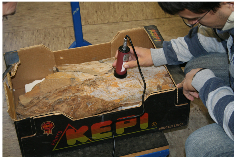
Abbildung 5.1.: Der versteinerte Dinosaurierknochen bei der Untersuchung durch das Handdosimeter der Firma Graetz Modell X5 DE . Man misst hier (500 \pm 300) nSv. In einem Abstand von 1 m findet man 100 \pm 50 nSv, ebenso für den Untergrund. In definiertem Abstand von 1 m zum untersuchten Dinosaurierknochen erfährt man also keine höhere Strahlenbelastung als ohnehin durch natürliche Strahlung gegeben ist. Die Maße des Knochens betragen 56 \times 30 \times 14 cm bei einer Masse von 20,9 kg.
