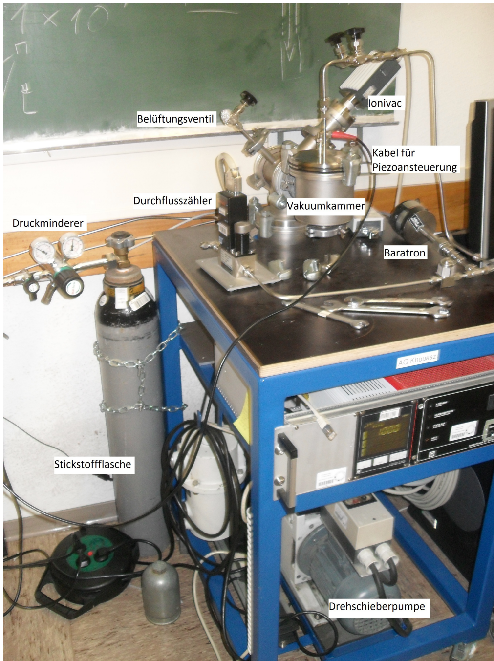
Abbildung 4.1.1: Foto vom Aufbau zur Durchflussmessung. Zu sehen ist die Stickstoffflasche (unten links), der Tisch mit dem Messaufbau (rechts) und die Drehschieberpumpe unter dem Tisch (unten rechts). Auf dem Tisch sind um die Vakuumkammer, in der sich die Düse befindet, die Messinstrumente (Baratron, Ionivac, Durchflusszähler), die die Eigenschaften des Stickstoffs messen, installiert.
