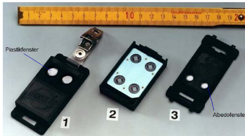
Abbildung 1.2: Bestandteile eines Albedodosimeters der Firma Harshaw. (1) ist die Vorderseite eines Albedodosimeters, (2) die darin befindliche Kassette mit den vier Lithiumfluoridkristallen und (3) ist die Rückseite des Albedodosimeters. [alb07]
