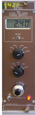
Abbildung 3.3: Hochspannungsquelle in der Arbeit über einen Hochpass.
