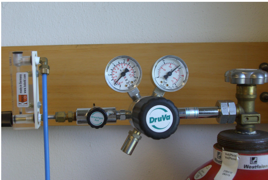
Abbildung 3.2: Gasflasche mit Durchflussregler
