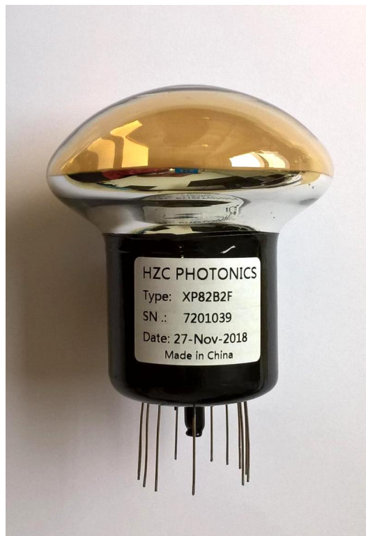
Abbildung 3.1.2: Bild eines der vier zur Charakterisierung verwendeten PMTs.
