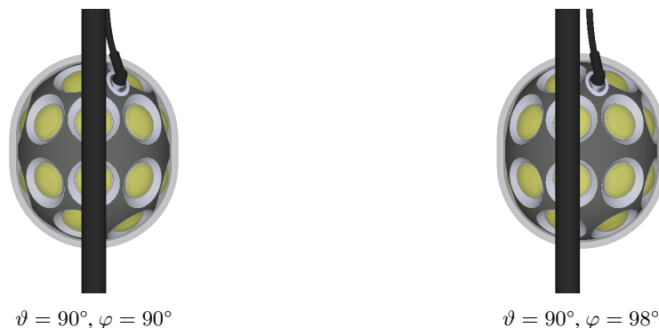
Abbildung 5.13: Darstellungen der Verschiebung des Hauptdatenkabels, wie sie in dieser Arbeit realisiert wurden. Links: Frontalansicht des verschobenen Hauptdatenkabels. Rechts: Der Einfallswinkel, unter welchem die Kabel am meisten abschatten, unterscheidet sich vom frontalen Einfallswinkel.
