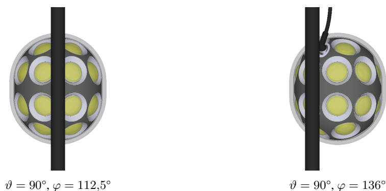
Abbildung 5.11: Links: Frontalansicht des Hauptdatenkabels. Die Abdeckung photosensitiver Fläche durch das Kabel beschränkt sich auf Teile der Reflektoren und der Photokathode der PMTs in der Umgebung. Rechts: Blickwinkel, der dem Winkel maximaler Abschattung durch die Kabel entspricht. Vier PMTs werden zu großen Teilen von den Kabeln verdeckt.
