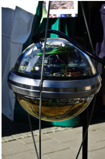
Abbildung 2.3.2: Bild eines zusammengebauten DOM. Auf der oberen Seite ist die Base zu sehen, die den Photomultiplier mit Spannung versorgt. Unten ist die gold reflektierende Photokathode des Photomultipliers sichtbar. Entnommen von [8].
