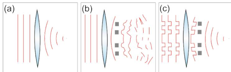
In (a) ist die Fokussierung einer ebenen Wellenfront durch eine Linse dargestellt. (b) Befindet sich eine Störung im Strahlengang, wird die Wellenfront verzerrt, sodass kein Fokus erzeugt werden kann. (c) Durch eine räumliche (Vor-)Formung der Wellenfront kann eine Störung im Strahlengang kompensiert werden.
