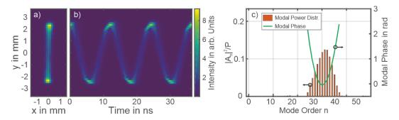
Links: Räumliches und raumzeitliches Strahlprofil eines transversal modengekoppelten Lasers, aufgenommen mit einer Fotodiode auf einem 2D-Verfahrtisch. Rechts: Mit Hilfe numerischer Methoden rekonstruierte modale Leistungsverteilung (orangefarbene Balken) und Phase (grüne Linie) des transversal modengekoppelten Strahls.
