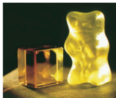
Abb. 1: Photorefraktiver, eisendotierter LiNbO 3 -Kristall zur Speicherung von Volumenhologrammen. Die bräunliche Färbung entsteht durch die Dotierung des Kristalls mit Eisenatomen, welche die für den photorefraktiven Effekt nötigen Ladungsträger zur Verfügung stellen.
