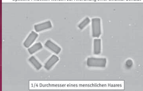
Optische Pinzetten werden zur Anordnung einer Struktur benutzt
