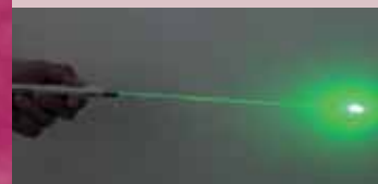
▲ Im Laserpointer wird grünes Licht aus infrarotem Licht erzeugt
