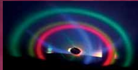
◀ Laserlicht erzeugt neue Farben in einem nichtlinearen Kristall
