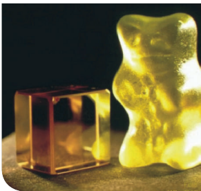
Photorefraktiver Bariumtitanatkristall im Größenvergleich | Photorefractive Bariumtitanat crystal compared in size (© J. Petter, TU Darmstadt)
