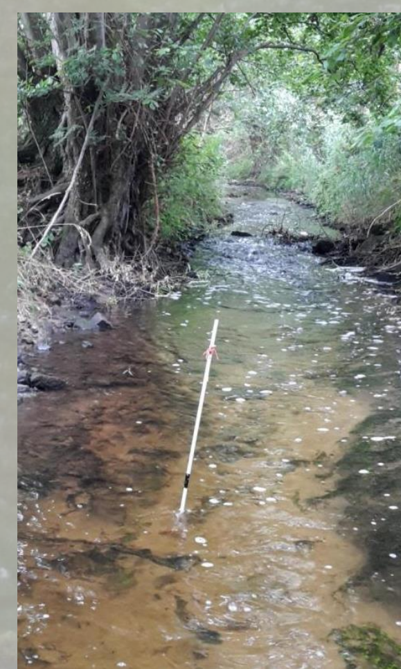
Abb. 11: Anbringung der Temperaturlogger im Gewässer.
