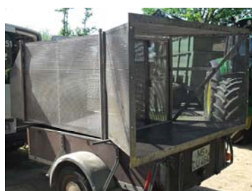
1 Für das Umgehungsgerinne angefertigte Reuse aus Edelstahl. Eigenes Foto.
