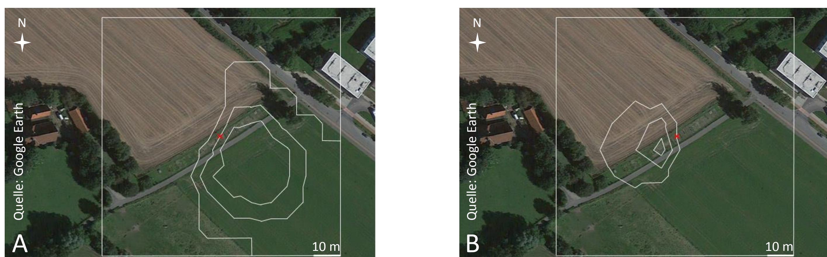
Abb. 2: Footprint für den 27.05. (A) und den 12.06. (B) für 40 %, 60 % und 80 % (von innen nach außen). Die rote Markierung zeigt den Messstandort.
