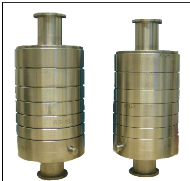
Abbildung 10: 5-stufige Berner-Impaktoren (links BT-Impaktor, rechts MS-Impaktor).
