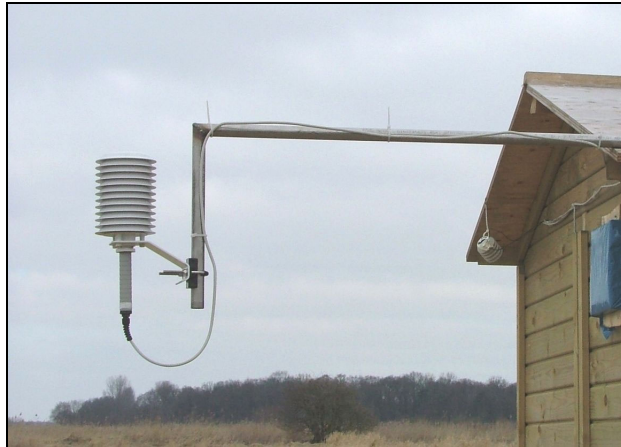
Abbildung 13: Feuchte- und Temperatursensor an der Messhütte.
