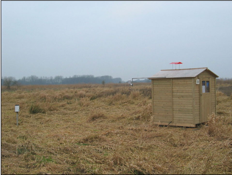
Abbildung 6: Messstation Rieselfelder mit Gartenhaus und Niederschlagssammler.
