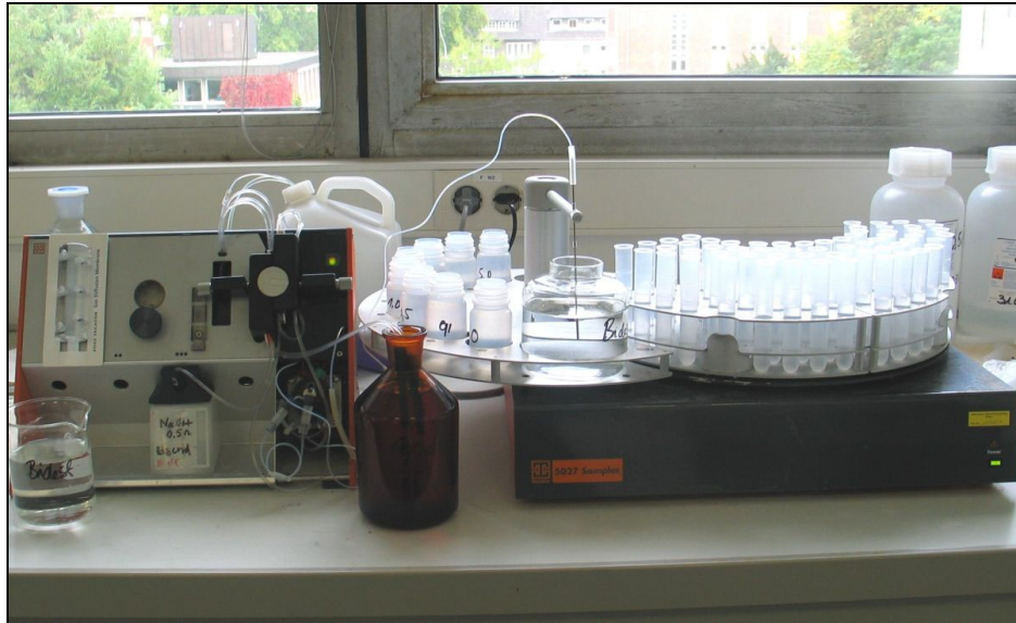
Abbildung 19: Aquatec Analyser 5400 mit Autosampler
