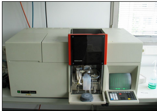
Abbildung 23: Flammen-Atomabsorptionsspektrometer Perkin Elmer 1100.
