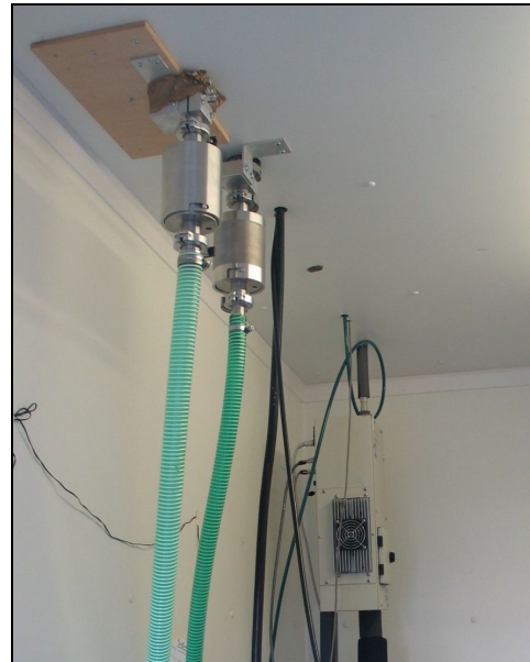
Abbildung 27: Zwei Impaktoren nebeneinander im Messcontainer Steinfurter Straße
