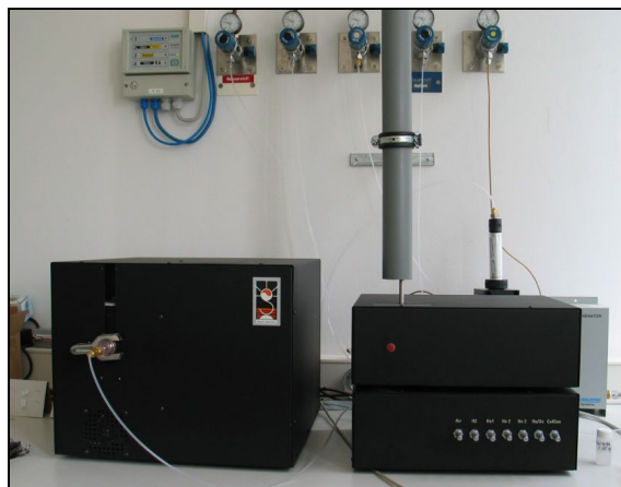
Abbildung 24: OCEC-Analyser von Sunset Laboratory mit Gasanschlüssen.
