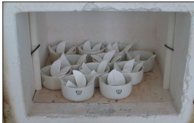
Abbildung 18: Geschnittene Quarzfilter in Keramiktiegeln im Muffelofen.
