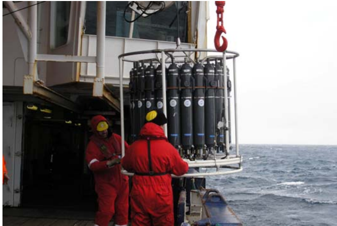
Abb. 25a: Wasserkransschöpfer an der Winde
