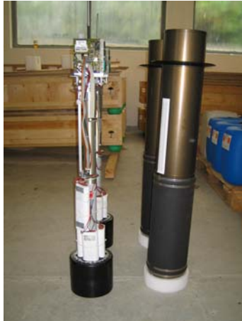
Abb. 10: Floatinneres mit Gehäuse
