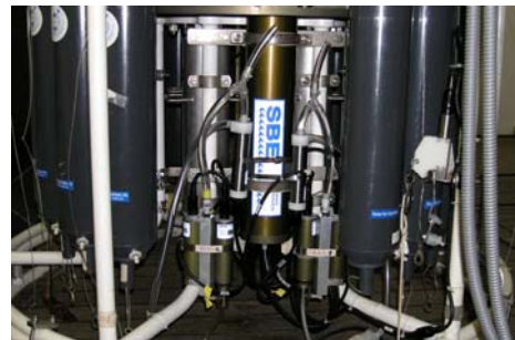
Abb. 24b: Im Wasserkransschöpfer eingebaute CTD.
