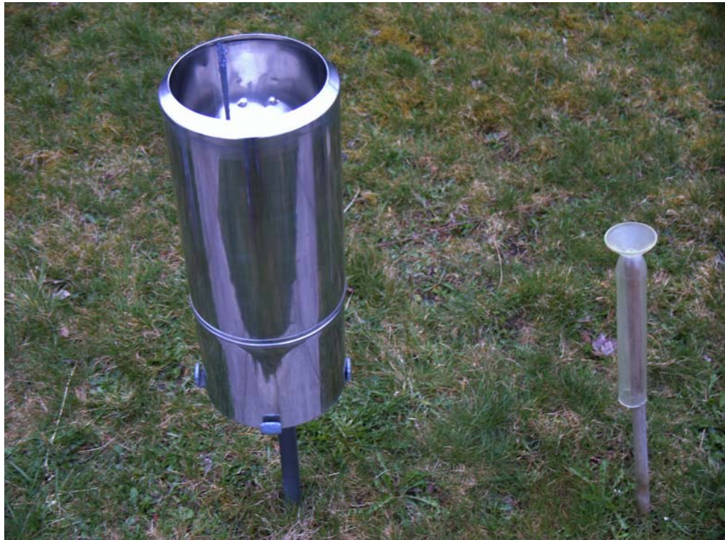
Abb. 3: Regenmesser nach Hellmann an der Flugwetterwarte des Flughafens Münster-Osnabrück
