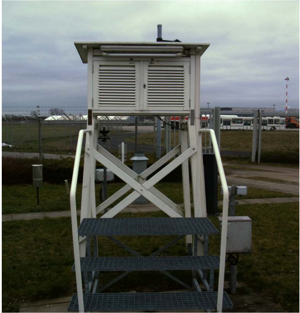
Abb. 7: Wetterhütte der Flugwetterwarte am Flughafen Münster-Osnabrück
