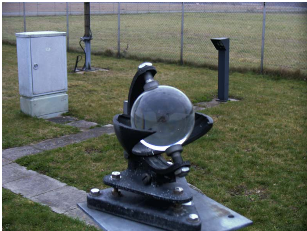
Abb. 8: Sonnenscheinautograph ohne Registrierpapier an der Flugwetterwarte des Flughafens Münster-Osnabrück
