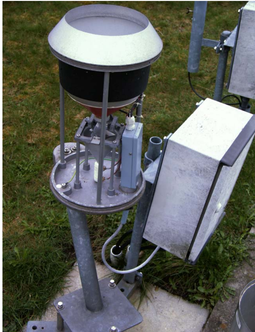
Abb. 5: Registrierender Niederschlagsmesser mit Wippenprinzip an der Flugwetterwarte des Flughafens Münster-Osnabrück
