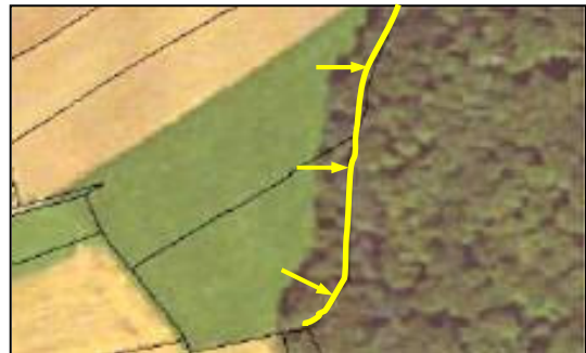
Abb. 2.5: Verschiebung durch den Neigungseffekt (Quelle: OESTERLE u. HAHN 2004, S.518, verändert)
