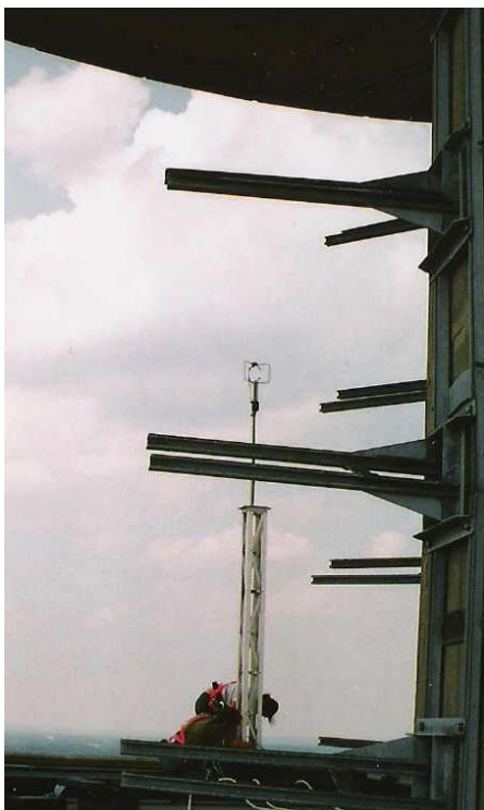
Abbildung 2.3 Aufbau der Messanlage auf dem Fernsehturm
